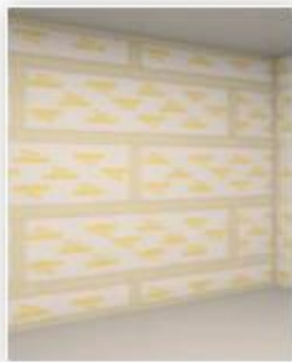
8. Αρμολόγηση οριζόντιων αρμών 2ης στρώσης
