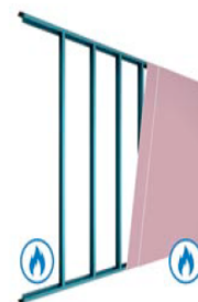
E.10 Αυτοφερόμενη Επένδυση μονού σκελετού 50/80, διπλής στρώσης RIGIPS Fireline 15 mm
