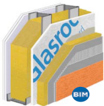
T.57 Εξωτερικός Τοίχος ειδικού μονού σκελετού 150/254, μονής στρώσης Glasroc X 12,5 mm εξωτερικά και διπλής εσωτερικά με HABITO και GYPROC VAPOR με ορυκτοβάμβακα και ΣΕΘ WEBER
