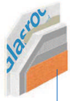
ΣΥΣΤΗΜΑ ΕΣΩΤΕΡΙΚΗΣ ΘΕΡΜΟΜΟΝΩΣΗΣ
